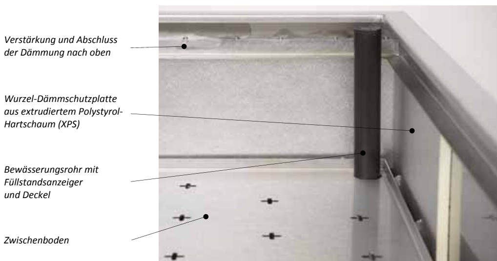
Technischer Aufbau Pflanztrog mit Wurzeldämmung und Bewässerungsrohr
